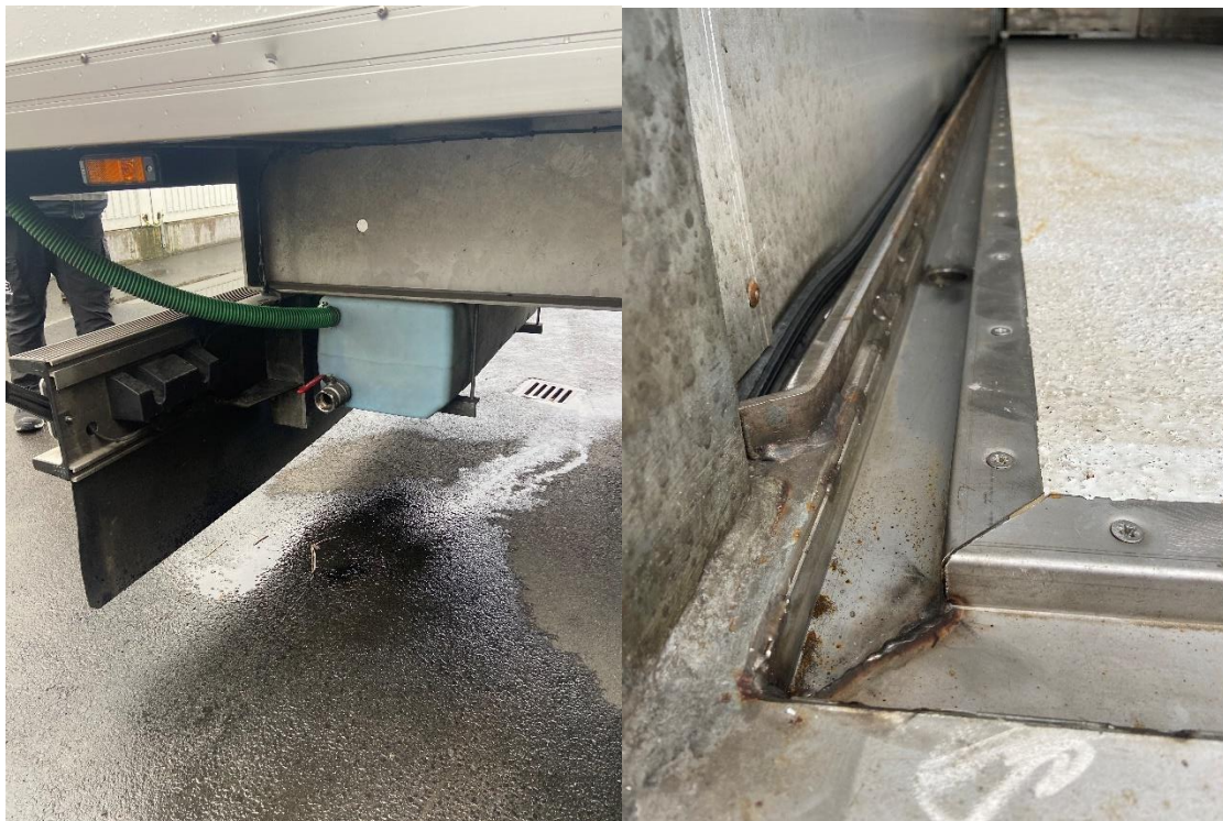
Bilde 2 Venstre: Oppsamlingskåp for smeltevann på islandsk lastebil. Tanken er cirka 100 liter stor og er festet i rammen bak på tralla. Høyre: Renne og avløpshull for oppsamling av smeltevann ved transport av fersk fisk på Island sett fra bakenden av tralla. (Foto: Bjørn Tore Rotabakk, Nofima)
